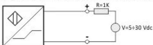
In assenza dell'azionatore metallico  $I \geq 3\text{mA}@8.2\text{V}$
