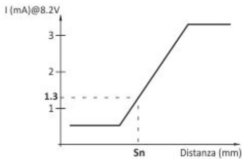
I sensori induttivi NAMUR sono rilevatori elettronici la cui corrente assorbita varia con l'avvicinarsi di un azionatore metallico.
