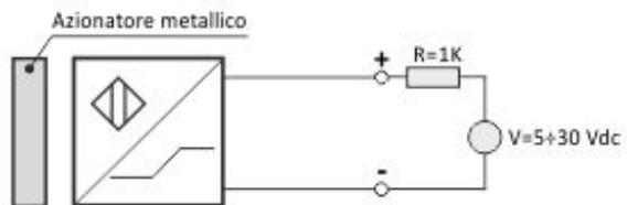
In presenza dell'azionatore metallico  $I \leq 1\text{mA}@8.2\text{V}$
